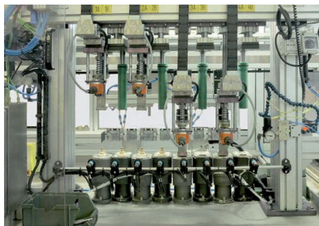
Impianto automatico di taratura ad acqua e ad aria delle cartucce termostatiche.
